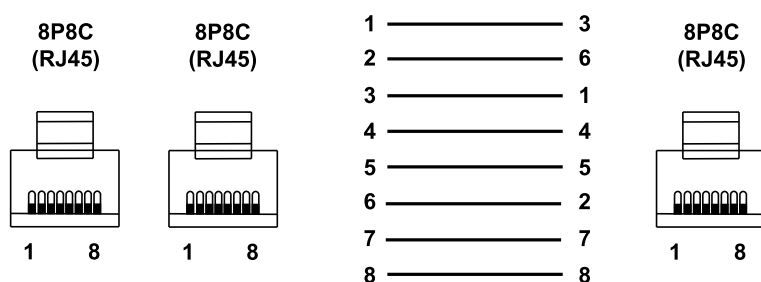
Рисунок 5.4 – Схема перекрестного кабеля для соединения прибора по сети Ethernet
